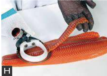
B: 豚肩肉の脂削ぎ E: 牛ボタン骨の除去 H: サーモンダークミート除去
