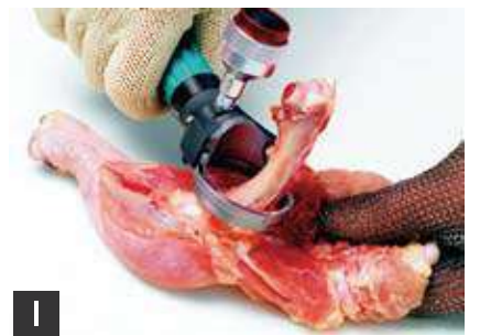
C: 豚肩肉のクッション部取外し F: 牛ストリップロインの脂削ぎ I: 鶏足骨外し
